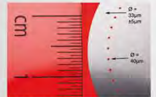
Edelstahl-Scheibe hochpräzise lasergeschnitten
